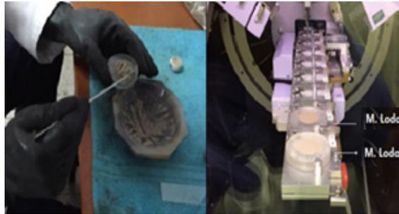
Figura 2 – Ensayo de DRX en el biosólido
