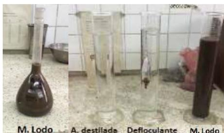
Figura 1 – Ensayo de laboratorio de densidad de sólido (Gs)
