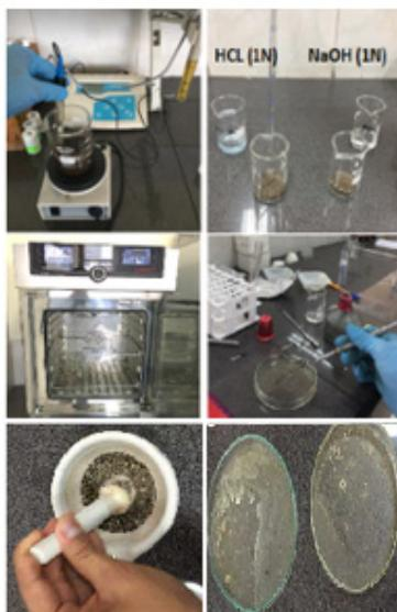
Figura 4 – Caracterización CRETIB de la muestra de biosólido
