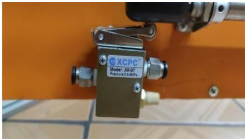
JM-07 Válvula neumática de accionamiento mecánico por rodillo 3/2, Puerto de 1/4"
